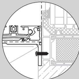
• **Tiefe Seitenführungen M.WS/M.WS+ für die seitliche Montage am Fensterrahmen**
